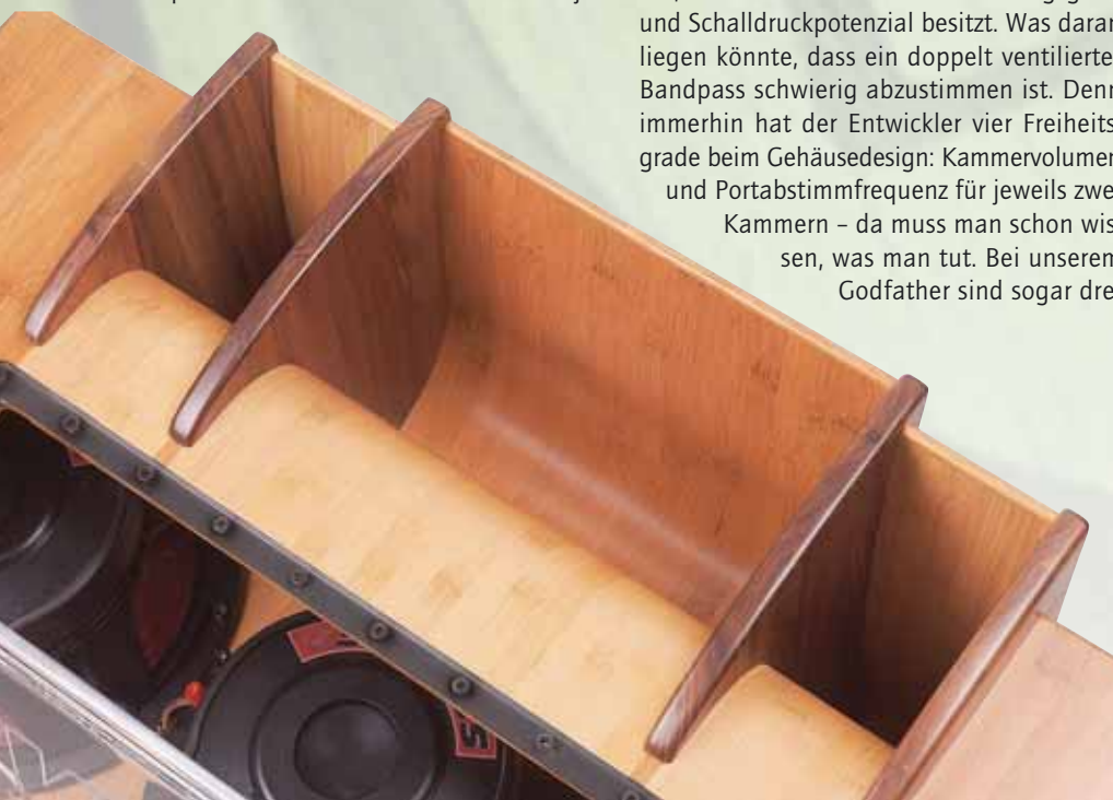
Der Godfather atmet durch reichlich bemessene Kanäle, die aufwendig aus gebogenem Material geformt sind
