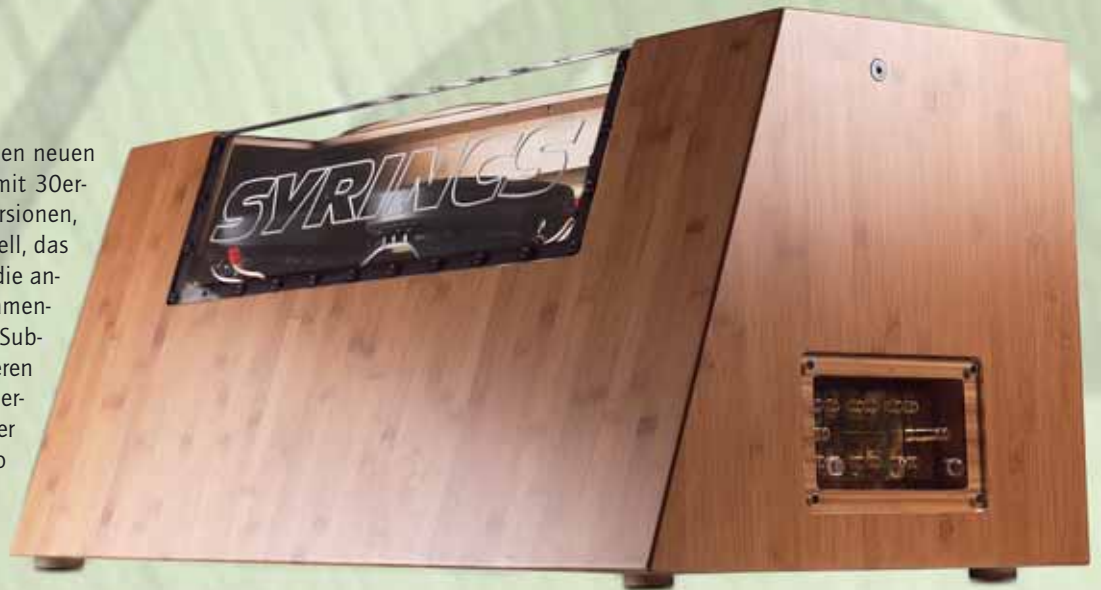
Das wunderschön gefertigte Gehäuse besteht beim Testwoofer aus Bambus. Es stehen jedoch andere Varianten zur Auswahl
